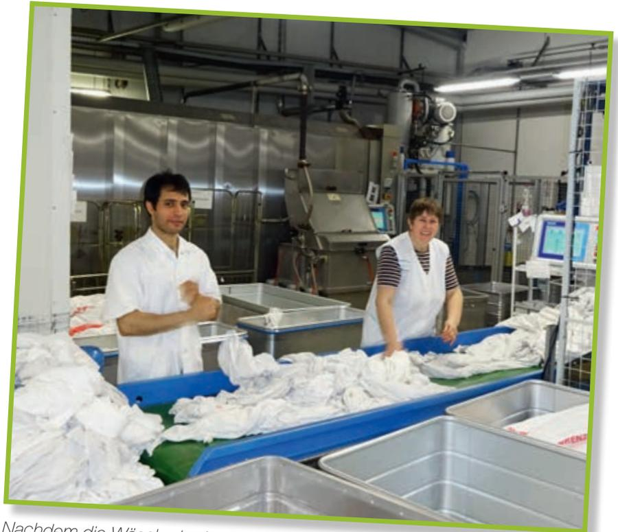
*Nachdem die Wäsche in der Presse vom Restwasser befreit und im Tumbler aufgelockert wurde, erfolgt die Sortierung in Wäschewagen für die weitere Bearbeitung in der Halle.*
