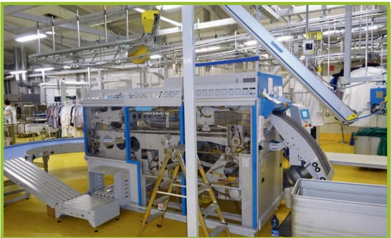
Mit dem neuen Finisher, dessen Falteinheit auf dem Bild zu erkennen ist, wird u. a. die Berufsbekleidung bearbeitet.
